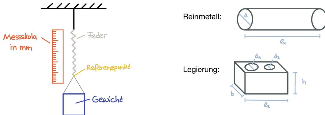
Abbildung 1: Versuchsaufbau mit Skizzen der beiden Probmassen
